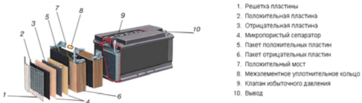
Рис 1. Конструкция необслуживаемой свинцово-кислотной аккумуляторной батареи с желеобразным электролитом
