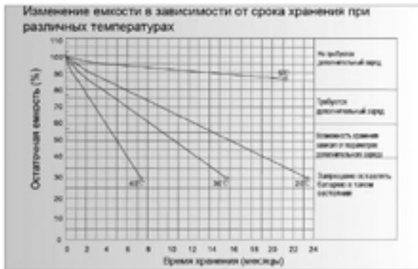
После транспортировки и хранения рекомендуется произвести заряд аккумуляторов в соответствии с таблицей ниже. Убедитесь, что после заряда и последующего отключения аккумулятора от зарядного устройства в течение 4 часов напряжение разомкнутой цепи (НРЦ) 12 В аккумулятора составляет не менее 13,10 В.
