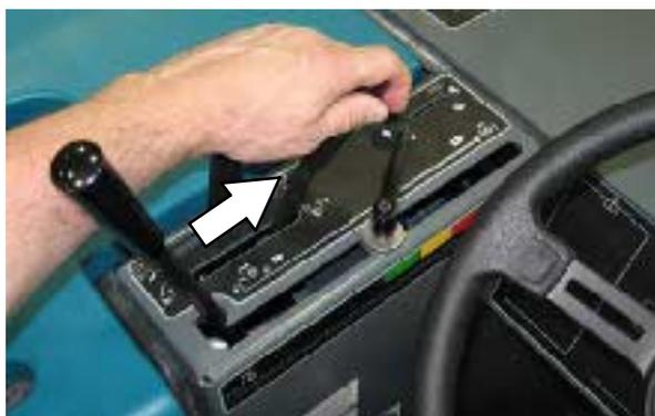
8. Потяните рычаг дверцы бункера назад и удерживайте в этом положении, пока не загорится индикация "Дверца бункера закрыта".
