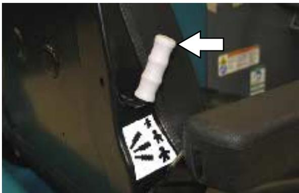
С помощью рукоятки регулировки наклона спинки установите нужный угол наклона спинки.
