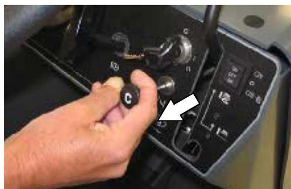
5. Поворачивайте ключ переключателя зажигания по часовой стрелке до тех пор, пока двигатель не запустится.
