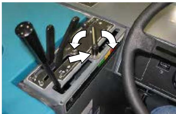
**ГОЛОВКА РЕГУЛИРОВКИ БОКОВОЙ ЩЕТКИ**
