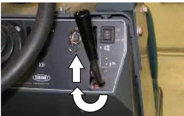
3. Потяните рычаг дверцы бункера назад и удерживайте в этом положении, пока не загорится индикация "Дверца бункера закрыта".
