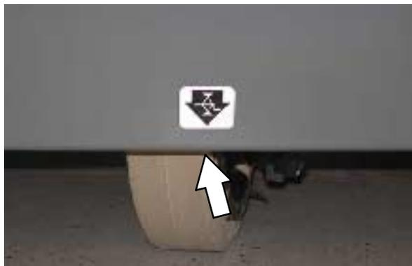
Места поддомкрачивания спереди располагаются на корпусе (раме) непосредственно перед передним колесом.
