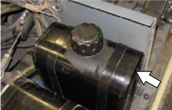
**ВНИМАНИЕ!** Не переполняйте резервуар гидравлической жидкости и не работайте на машине при низком уровне гидравлической жидкости в резервуаре. Иначе может произойти повреждение гидравлической системы.
