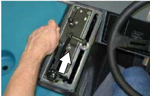
**!** **ПРЕДУПРЕЖДЕНИЕ:** зона защемления подъемного рычага. Не приближайтесь к подъемным рычагам бункера.
