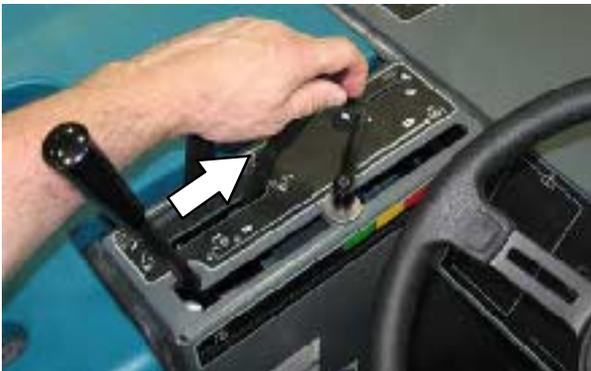
4. Переведите рычаг вытяжного вентилятора и встряхивателя фильтра в положение **Вытяжной вентилятор Вкл.**
