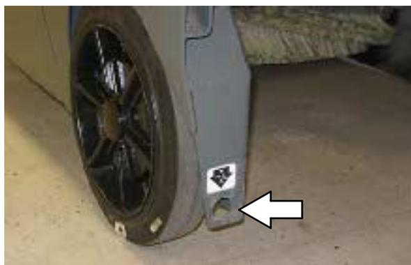
Расположенные на тыльной стороне машины места швартовки представляют собой отверстия в боках рамы машины рядом с задним бампером.
