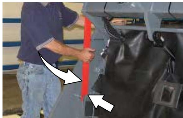
**⚠ ПРЕДУПРЕЖДЕНИЕ:** поднятый бункер может упасть. Установите опорную балку бункера.
