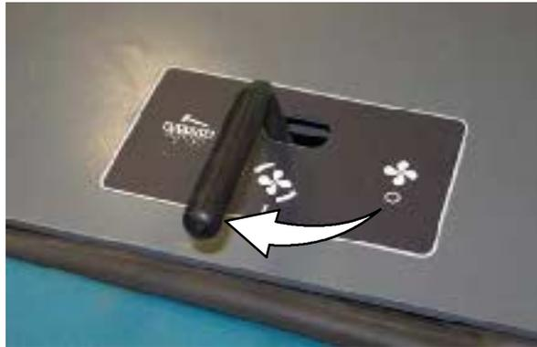
*ПРИМЕЧАНИЕ: При подметании влажного мусора канал вытяжного вентилятора должен быть закрыт.*
