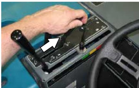
12. Переведите рычаг вытяжного вентилятора и встряхивателя фильтра в положение **Вытяжной вентилятор Вкл.**
