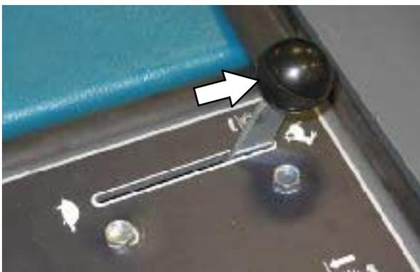
4. Потяните назад и удерживайте в этом положении рычаг подъема / опускания бункера для поднятия бункера на нужную высоту. Отпустите рычаг в положение **Удерж.**
