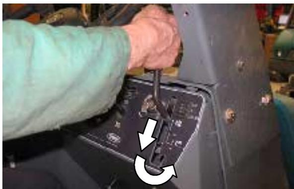
4. Выполните встряхивание пылеулавливающего фильтра, удерживая рычаг вытяжного вентилятора и встряхивателя фильтра в положении **Встряхиватель фильтра** в течение 30 секунд.
