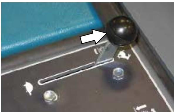
8. Снимите машину со стояночного тормоза.
