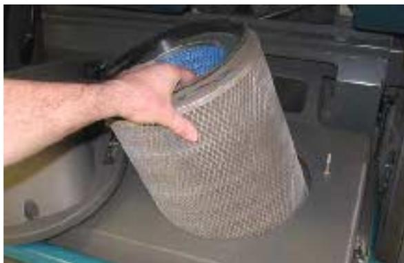
4. Очистите или утилизируйте элемент пылеулавливающего фильтра. См. **ОЧИСТКА ПЫЛЕУЛАВЛИВАЮЩЕГО ФИЛЬТРА.**
