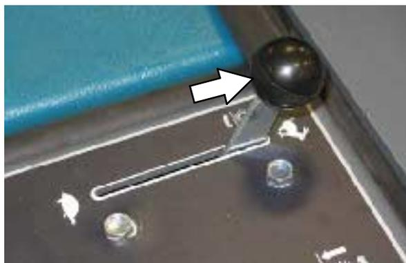
10. Потяните рычаг дверцы бункера назад и удерживайте в этом положении, пока не загорится индикация "Дверца бункера закрыта".
