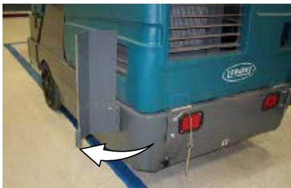
3. Перед эксплуатацией машины закройте и закрепите бамперы.
