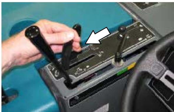
11. Переведите рычаг вытяжного вентилятора и встряхивателя фильтра в положение **Вытяжной вентилятор Вкл.**
