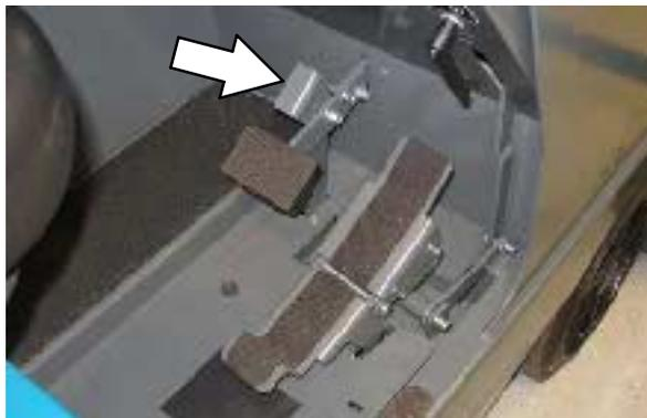
*ПРИМЕЧАНИЕ: Если оператор отсутствует на сиденье, включается стояночный тормоз или машина автоматически выключается по истечении 2 секунд.*
