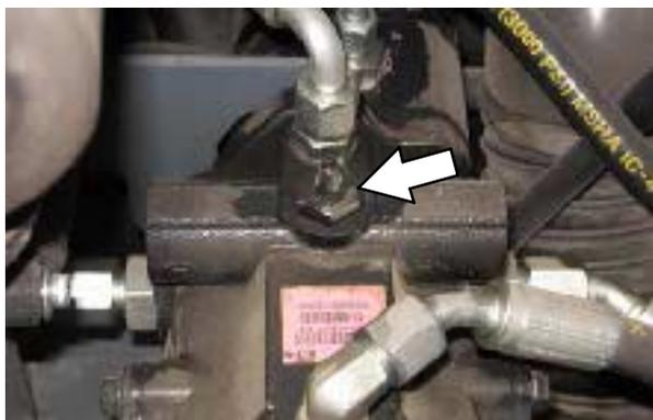
**ВНИМАНИЕ!** Не толкайте и не буксируйте машину на большие расстояния и без использования перепускного клапана, иначе можно повредить гидравлическую систему машины.
