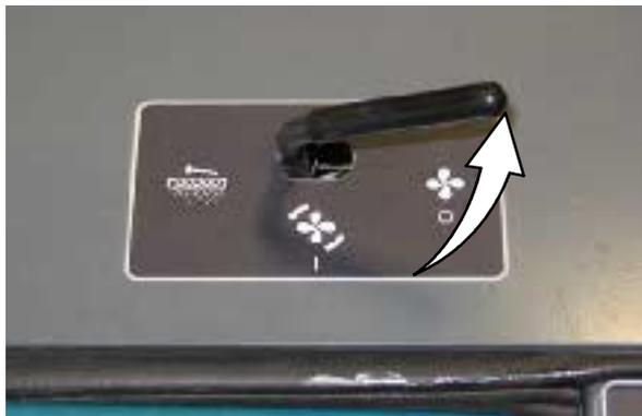
*ПРИМЕЧАНИЕ: При наличии в бункере избыточного тепловыделения рычаг вытяжного вентилятора и встряхивателя фильтра под действием Термосторожа переместится в положение **Вытяжной вентилятор Выкл.** Кроме того, из-за этого же загорится лампочка сигнализации о высокой температуре в бункере. В этом случае остановите машину, устраните источник тепловыделения и верните рычаг в положение **Вытяжной вентилятор Вкл.***
